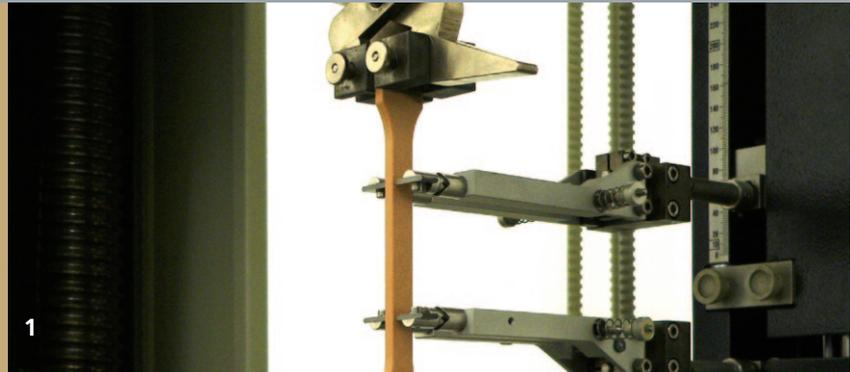
1 Zugprüfung mit mechanischem Dehnungsaufnehmer
